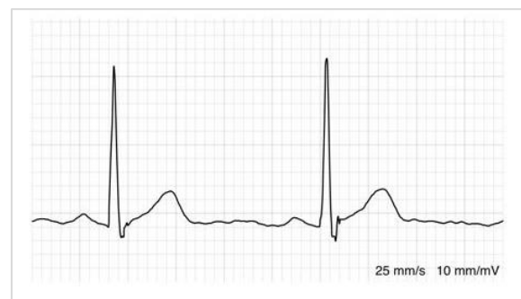
Sinal ECG após deteção e filtragem de QRS Pan-Tompkins
