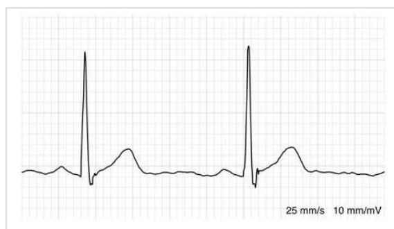
Segnale ECG dopo il rilevamento e il filtraggio dei QRS Pan-Tompkins
