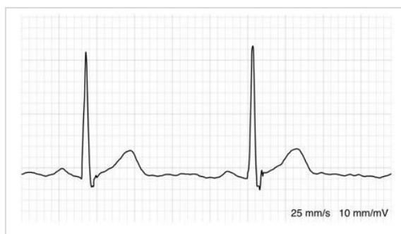
Señal de ECG después de la detección y el filtrado de QRS por Pan-Tompkins
