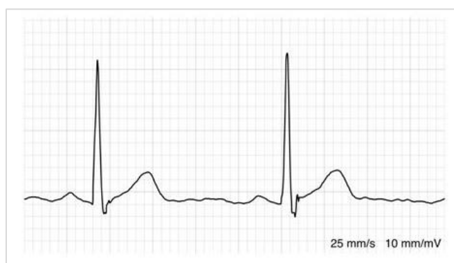
EKG-signal efter Pan-Tompkins QRS-detektion og -filtrering
